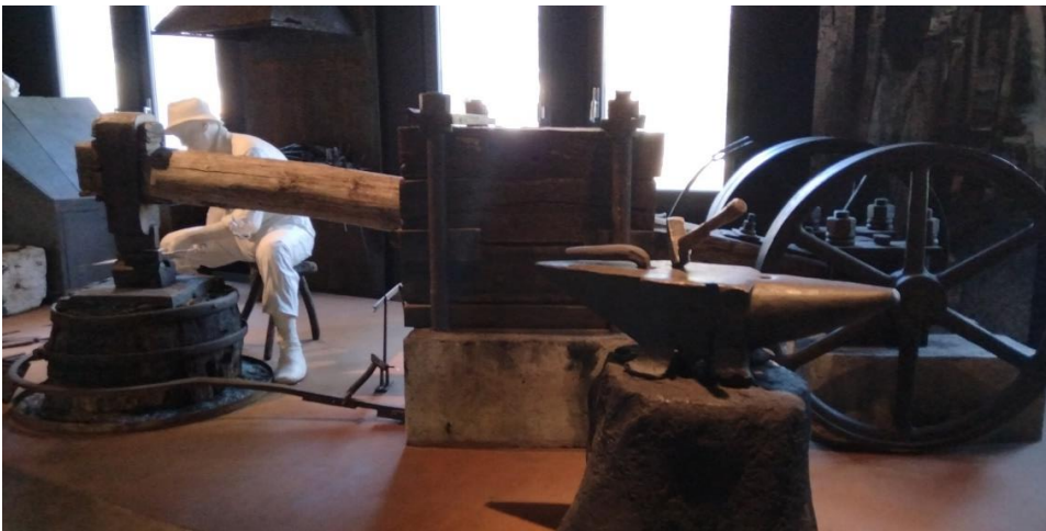
Fig. 2.1 e 2.2 – Maglio a testa d'asino esposto al museo dell'Arte Fabbri e delle Coltellerie di Maniago
